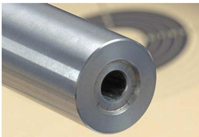
Blick auf die massive, hinterdrehte Mündung des Matchlaufs. Der Topstreukreis mit Sellier & Bellot Match Fabrikmunition maß gerade einmal sechs Millimeter.
