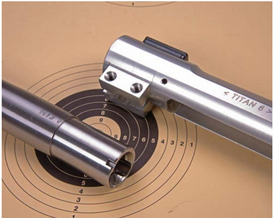
**Blick auf den Lauffortsatz mit Verriegelungskulisse. Die simple Sicherung gegen ein Verdrehen des Laufs beziehungsweise gegen einen inkorrekten Einbau besteht aus einem Schienenstück in der vorderen Systemhülsenbrücke und einer Nut im Lauf.**
